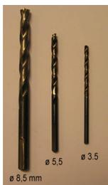
Punte con spirale allargata e punta bloccante per fori precisi senza occlusioni
